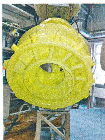
Рис. 3. Общий вид модельного блока с нанесенным керамическим слоем суспензии для последующих слоев ВТ-1202В
