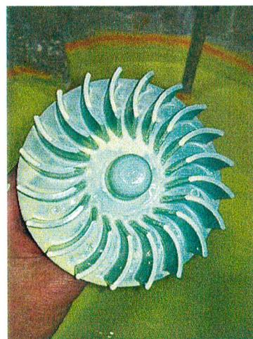
Рис. 1. Общий вид восковой модели из МК КС 3898 с керамическим слоем на основе связующего марки ВТ-1101П
